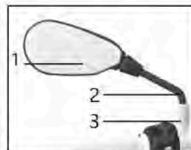
Couple serrage ecrou (3): 40Nm
