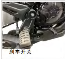
刹车开关：Ecrou de réglage du contacteur de frein
